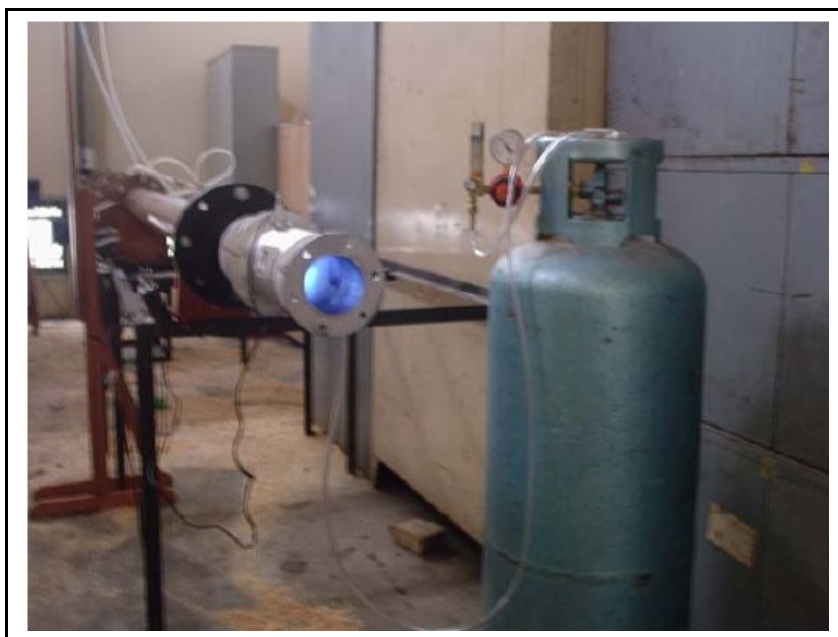
Figura 1: Ensaio da câmara de combustão da microturbina desenvolvida no LETE, da Poli-USP.
